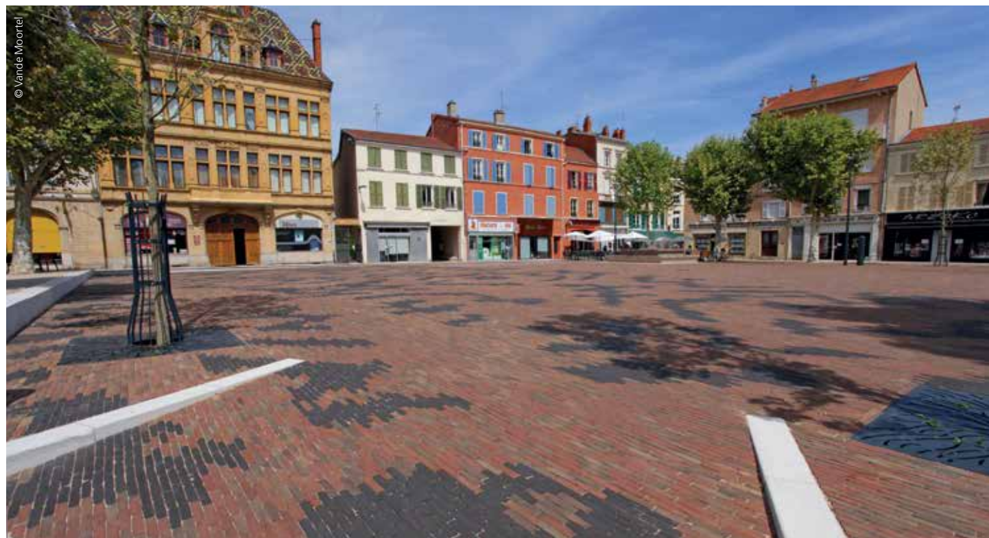
Originaux, les pavages en terre cuite s'invitent doucement dans l'espace public. Ils absorbent peu d'eau, sont résistants au gel, offrent une surface antidérapante et restent 'esthétiques' pendant des décennies (100 ans, voire plus).
