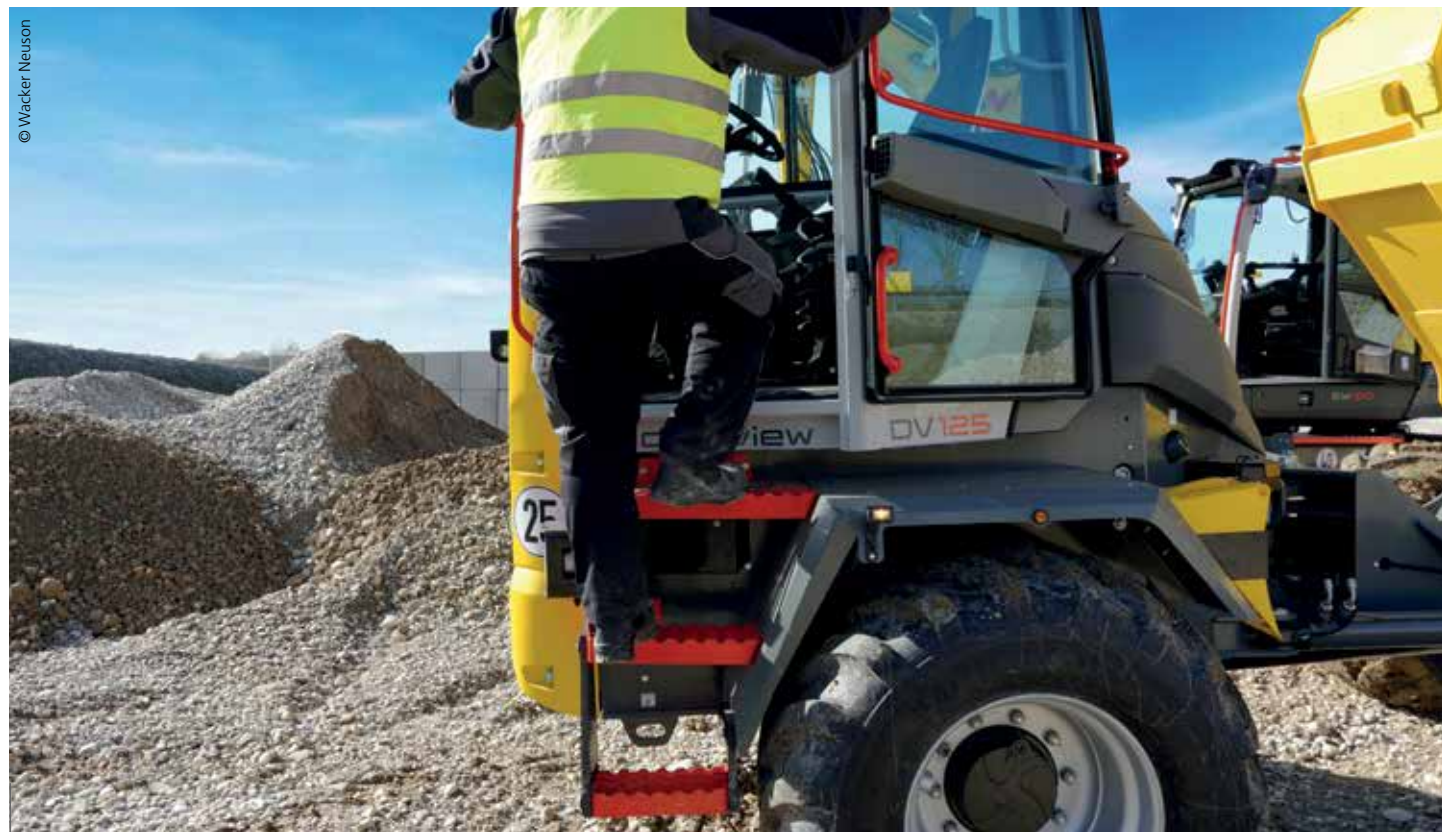
Monter à bord d'un véhicule et en descendre de façon répétée peut se révéler traumatique pour le dos. La présence de marches pieds adaptés, de poignées ergonomiques et d'un siège amortissant à l'intérieur soulagent les opérateurs.
