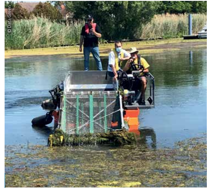
Faucardage et ramassage de plantes invasives aquatiques (ici modèle MC101 Conver, distribution Data Green). Les éliminer réduit leur surface de développement, restaure l'écoulement de l'eau et empêche l'envasement des plans d'eau.
