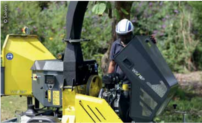
Sur certains modèles de broyeurs, les contrôles regroupés à hauteur d’homme (levier de vitesse moteur, vitesse du système ameneur, écran de contrôle...) évitent à l’opérateur de se baisser. L’accès au moteur est aussi facilité par une simple ouverture du capot.
