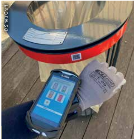
Avec l'application i-apps de Sineu Graff, l'agent récolte et communique des informations sur chaque corbeille (volume collecté, présence de dépôts sauvages, niveau de remplissage...) pour optimiser la collecte.
