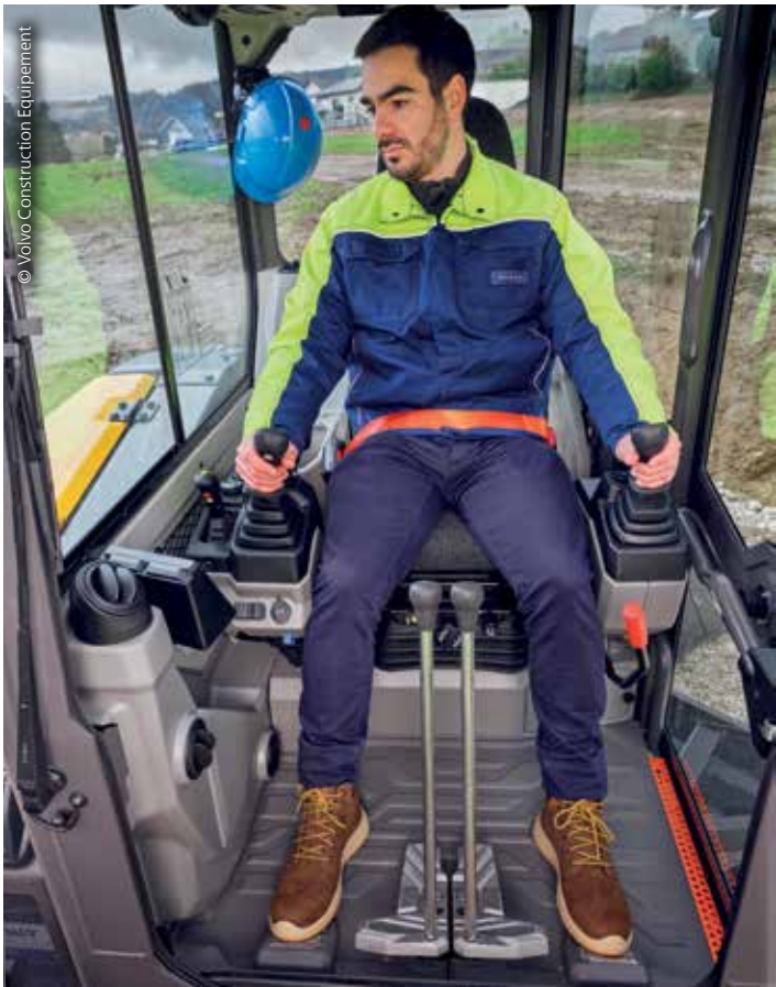
La visibilité sur les travaux et l’espace accordé aux jambes limitent les douleurs lombaires.
