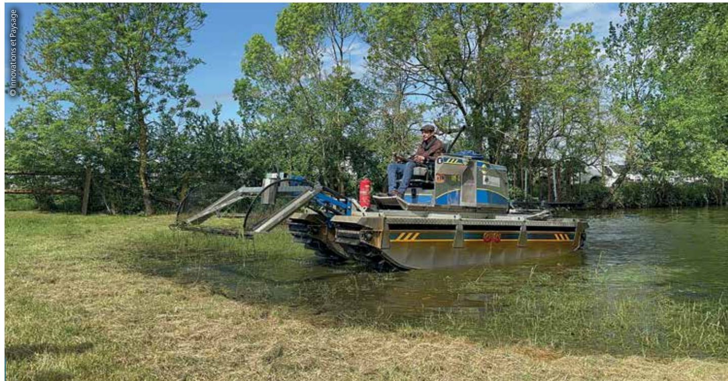
Des modèles amphibies (ici T50 de Truxor, distribution Innovations et Paysage) accèdent directement aux plans d'eau depuis les berges, sans besoin de grutage, pour aller 'faucher' (et ramasser) les invasives.
