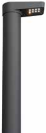
Hautes de 1,1 m, les bornes Speredenn de Comatelec Schröder diffusent une température de couleur de 2 700 K. Le tube profilé est en aluminium. © Comatelec Schröder
