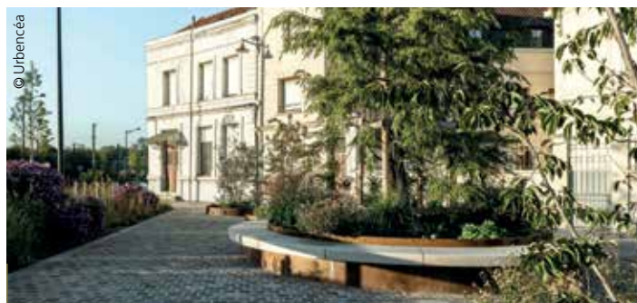
En acier thermolaqué ou Corten, l’îlot ‘vert’ Illa d’Urbencéa possède un diamètre maximal de 4,3 m. Les assises sont en béton ou en pierre.
