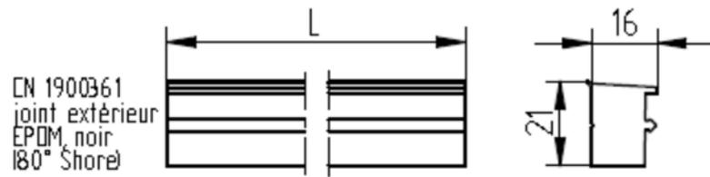
Figure 7 – CROSILUX 2.0 LIGHT – Joint extérieur
