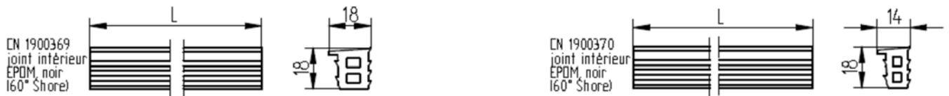
Figure 8 – CROSILUX 2.0 LIGHT – Joint intérieur
